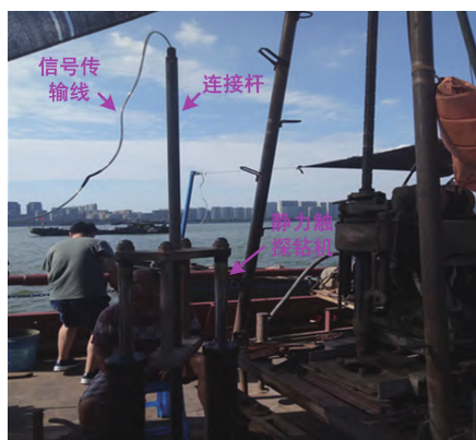
(a) 气体探头压入江底沉积物的现场测试图
